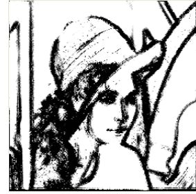
図 5 差分入力 SWCNN システムによるエッジ検出結果。 I = -0.53, u_{min} = 0.001, u_{max} = 0.2, Lm = 4 。
