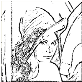
図 4 提案する SWCNN を用いたエッジ検出結果。 I = -1.0, u_{min} = 0.001, u_{max} = 0.2, Lm = 4 。
