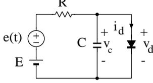
Fig. 4 Diode circuit.  $R=1[\text{k}\Omega]$ ,  $C=1[\mu\text{F}]$ ,  $E=1[\text{V}]$ ,
